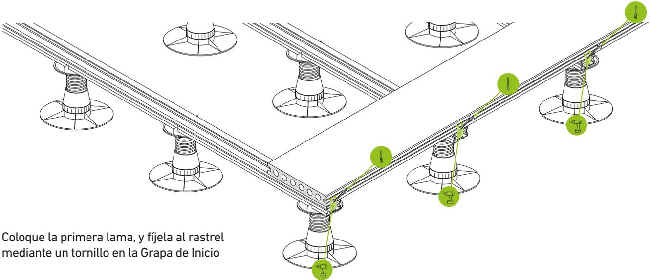
Coloque la primera lama, y fíjela al rastrel mediante un tornillo en la Grapa de Inicio
