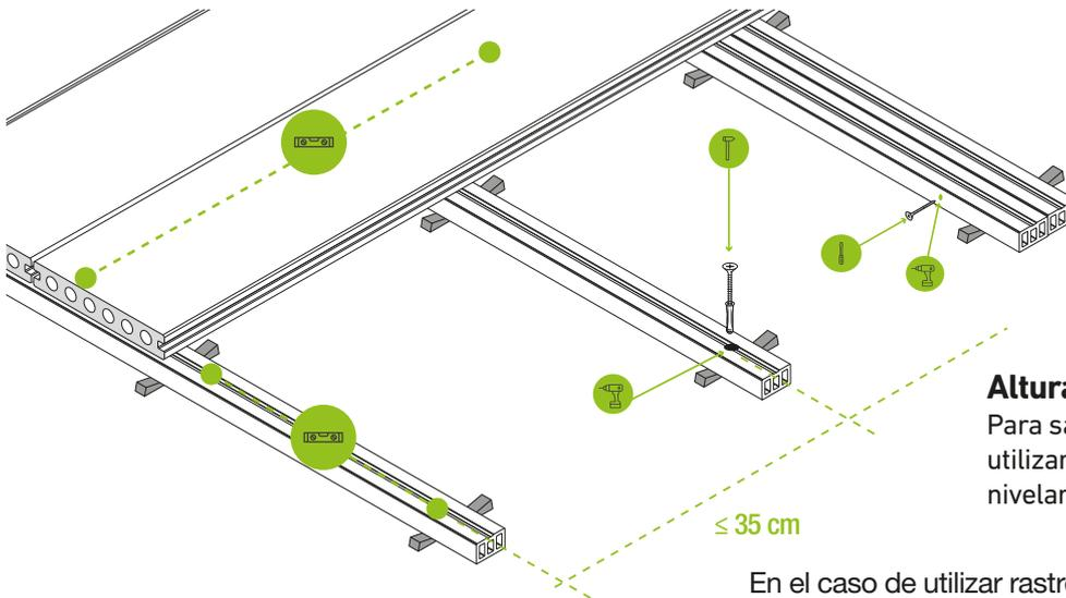
Para fijarlos al suelo podemos taladrar el rastrel y el hormigón, colocando un taco de impacto que sujete ambos o utilizar colas de poliuretano en caso que no podamos taladrar el suelo existente.
